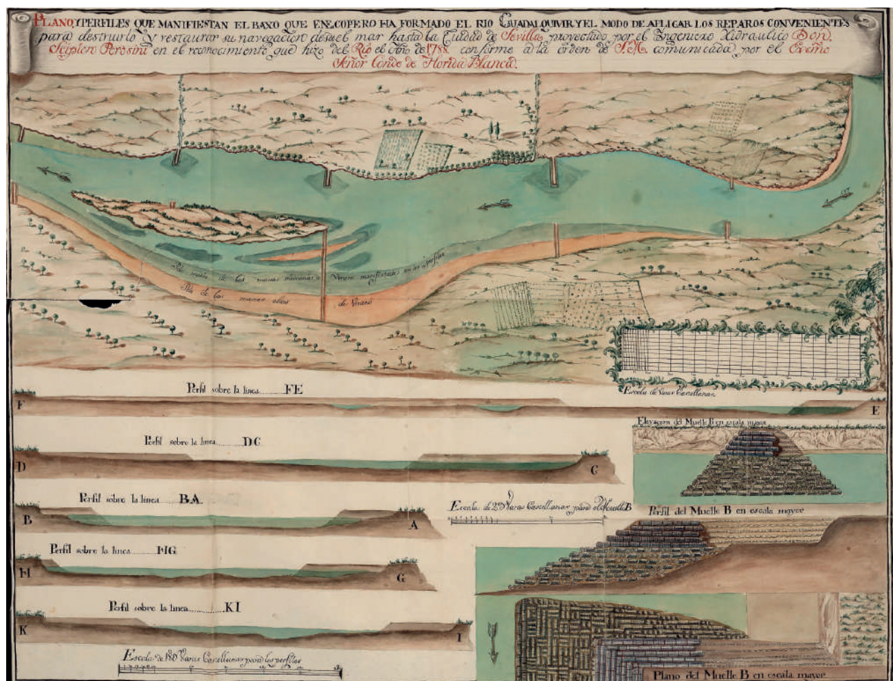
“Plano y perfiles que manifiestan el baxo que en El Copero ha formado el río Guadalquivir y el modo de aplicar los reparos convenientes para destruirlo y restaurar su navegación desde el mar hasta la ciudad de Sevilla, proyectado por el yngeniero hidráulico don Scipión Perosini en el reconocimiento que hizo del río el año de 1788, conforme a la orden de Su Magestad, comunicada por el excelentísimo señor conde de Florida Blanca”. Biblioteca Nacional.
