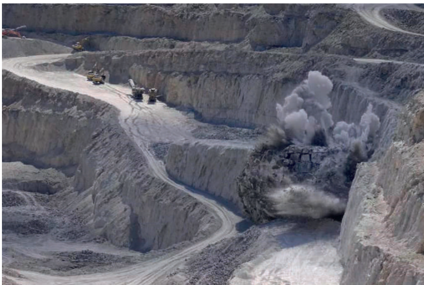
Voladura de mineral de yeso en Sorbas (Almería). Fotografía de Javier Alonso para Diario de Almería .
